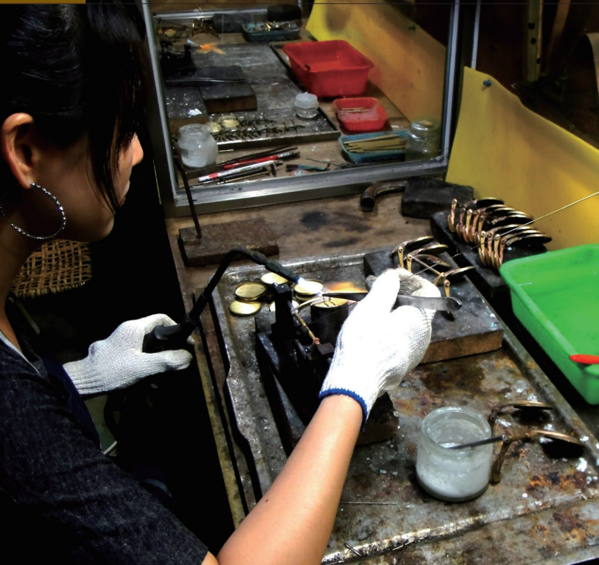
▲美冠樂器的作業員示範薩克斯風零件錫焊作業。
